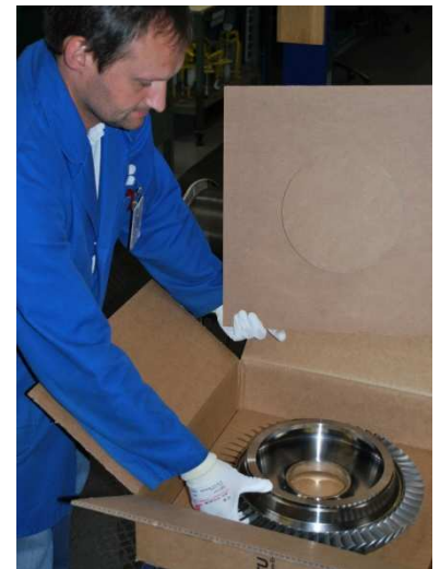
Mit Hilfe von speziell angefertigten Einsätzen (oben) kann Hubert Bayerle das Bauteil in seiner Verpackung exakt zentrieren (rechts).
