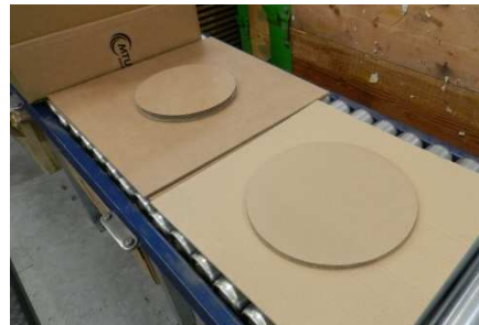
Mit Hilfe von speziell angefertigten Einsätzen (oben) kann Hubert Bayerle das Bauteil in seiner Verpackung exakt zentrieren (rechts).
